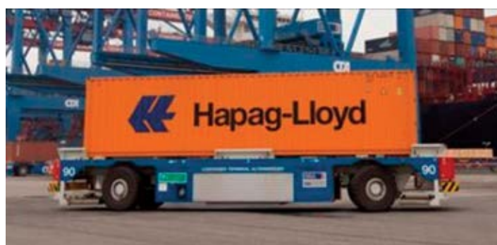
Automated Guide Vehicle (AGV). Fuente: Vehículo de guiado automático de la empresa TEREX en el puerto de Hamburgo, Alemania. http://www.cidesport.com.br
