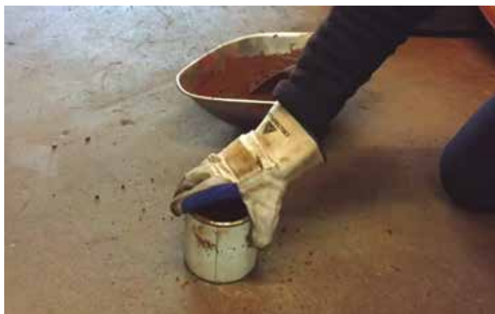
Prueba de la lata para licuefacción de la carga, Fuente: Safety4Sea, "Liquefaction testing is inadequate, ABTO says", 23 de junio de 2017.
